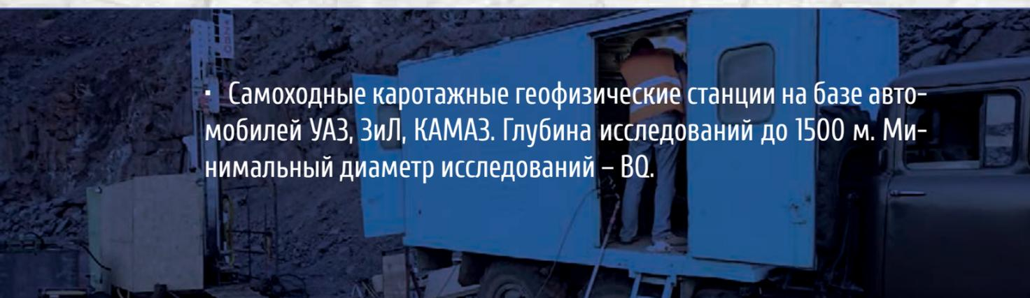
• Самоходные каротажные геофизические станции на базе автомобилей УАЗ, ЗиЛ, КАМАЗ. Глубина исследований до 1500 м. Минимальный диаметр исследований – 90.
